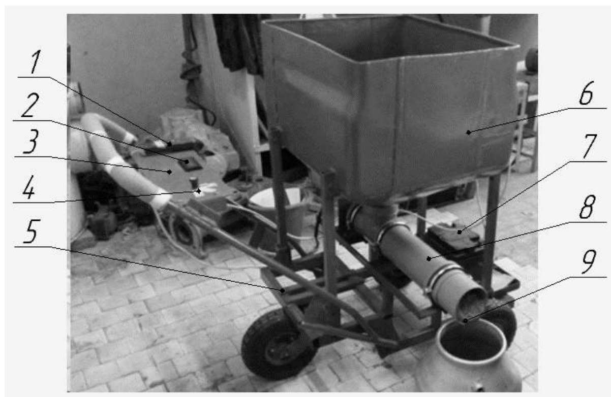
Рис. 1. Мобильный раздатчик кормов со спирально-винтовым дозатором:
