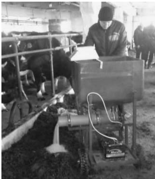
Рис. 3. Процесс дозированной раздачи комбикормов спирально-винтовым дозатором
