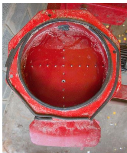
Рис. 2. Схема расположения отверстий на торцевой крышке для замера скорости воздушного потока в камере дробилки зерна ударно-отражательного действия: а – схема расположения отверстий; б – общий вид крышки с отверстиями
