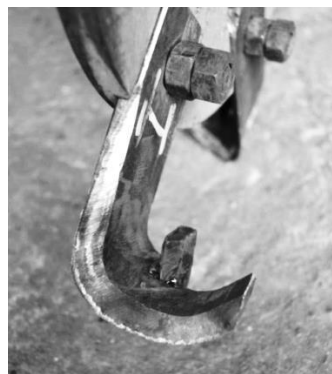
Рис. 2. Усовершенствованный L-образный нож: 1 – стойка ножа; 2 – крыло; 3 – отогнутая часть крыла; 4 – рыхлитель; 5,6 – режущая часть
