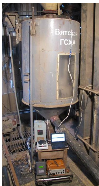
Рис. 1. Схема размещения устройства контроля и управления технологическим процессом пневмосепаратора:
