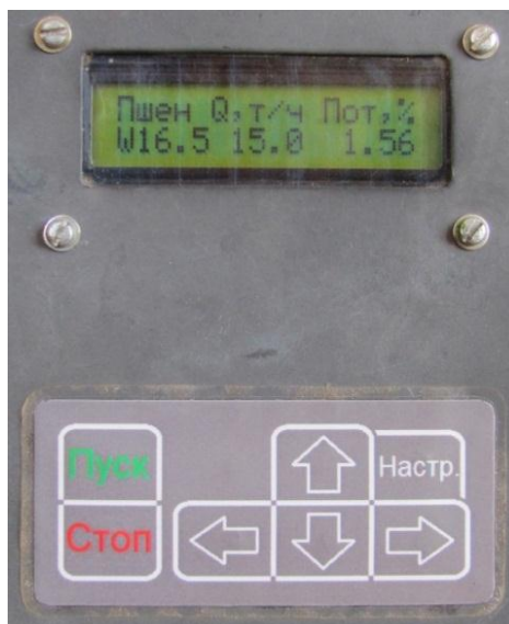
Рис. 3. Базовый блок устройства контроля и управления технологическим процессом пневмосепарации зерна
