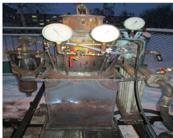
Рис. 4. Общий вид экспериментальной газогенераторной установки
