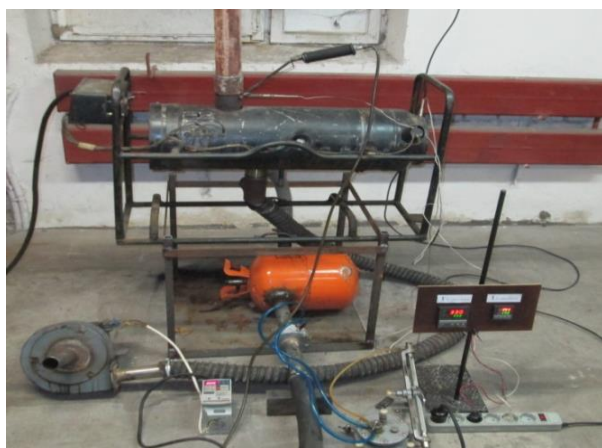
Рис. 3. Работа ОВ - 95 на генераторном газе
