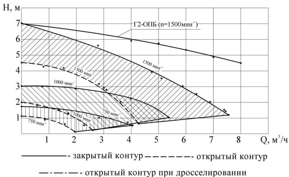
Рис. 6. Напорные характеристики устройства ввода и смешивания сыпучих компонентов с жидкостью
