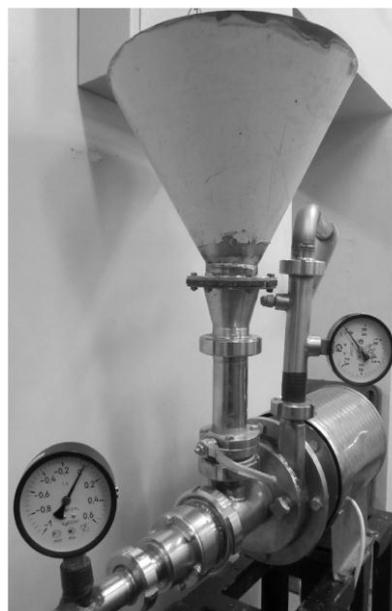
Рис. 7. Схема (а) и общий вид (б) устройства смешивания сыпучих компонентов с жидкостью
