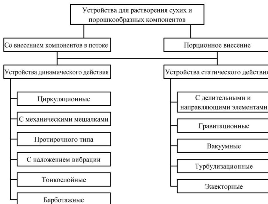
Рис. 1. Классификация устройств смешивания и растворения сухих и порошкообразных компонентов
